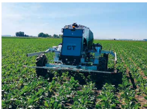
Cosunin peltopäivässä esiteltiin saksalainen Farming GT, autonominen kasvisuojelurobotti. Haraus perustuu konenäköön ja koneella voi myös ruiskuttaa.
