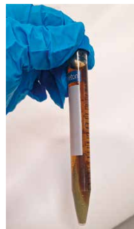
Sentrifugoitua proteiinieristettä. Putkessa oleva päällimmäinen neste otetaan talteen ja putken pohjalla oleva massa heitetään pois.
