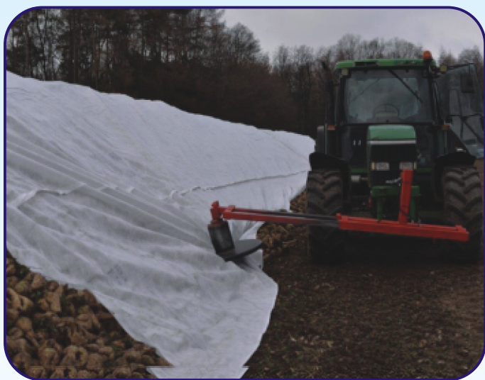
Za pomocą tej maszyny włóknina jest wciskana w głąb przyzmy
